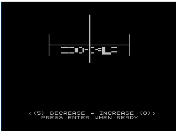
**Der berüchtigte Lenslok-Schutz, hier bei „Elite“ für den ZX Spectrum, zeigt auf dem Bildschirm ein Pixelmuster, das sich nur durch eine auf die Bildröhre aufgesetzte Linse mit einem Kunststoffprisma entziffern lässt.**
