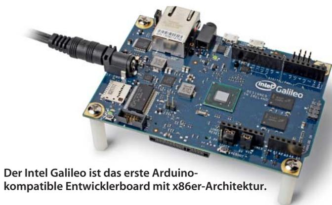
Der Intel Galileo ist das erste Arduino-kompatible Entwicklerboard mit x86er-Architektur.
