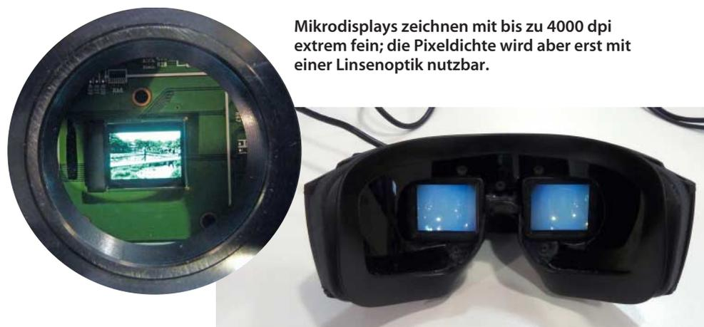
Mikrodisplays zeichnen mit bis zu 4000 dpi extrem fein; die Pixeldichte wird aber erst mit einer Linsenoptik nutzbar.
