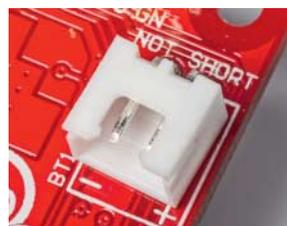
PiUSV und StromPI benutzen sehr solide Plastikklammern, die so ziemlich alles greifen, was nach Draht aussieht. Die Blechklammern an der PiUSV+ sind weniger fummelig, wenn der Leiter genau die richtige Dicke und Steife hat. Auf der UPS Pico sitzt eine Buchse für Stecker, wie man sie oft an kleinen LiPo-Akkus für Quadrocopter und Co. findet.
