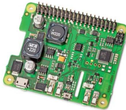
Nutzt und lädt Lithium-Ionen Akkus und kommt mit fertiger Software für den USV-Betrieb: PiUSV+ für alle neueren Raspis
