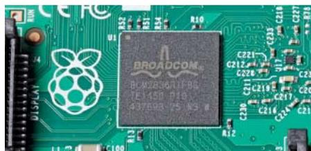
**Broadcom BCM2836: 4 ARMv7-Kerne mit 900 MHz statt eines ARMv6-Kerns mit 700 MHz beim Raspberry Pi 1.**
