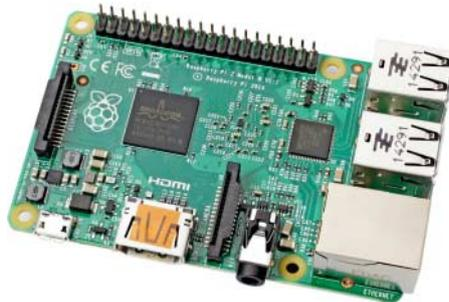
**Außer dem System-On-Chip namens BCM2836 unterscheidet fast nichts den Raspberry Pi 2 vom Vorgänger.**
