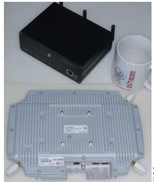
**Mit einer Basisstation wie der SysmoBTS (oben) oder der nanoBTS lässt sich ein Mobilfunknetz simulieren, um den Datenverkehr des eingebuchten Steuergeräts zu belauschen.**
