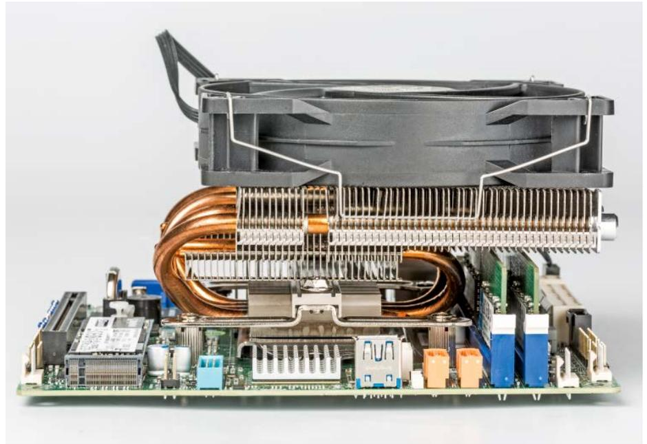
**Alternativ kühlt auch der Shadow Rock LP von be quiet! in der gezeigten Ausrichtung mit absaugend montiertem Lüfter den Xeon E-2288G gerade noch ausreichend.**
