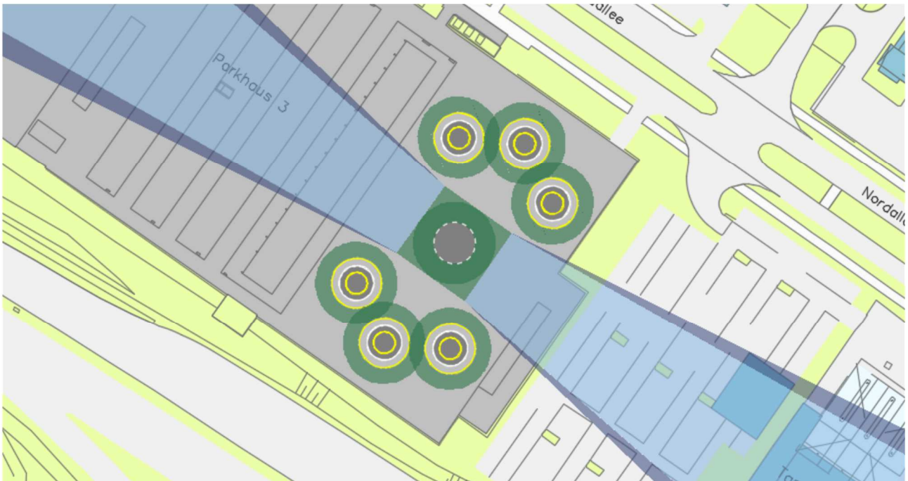
Abbildung 37: P3 Vertiport für 12 Meter größte Gesamtabmessung eVTOL, Konfiguration 2
