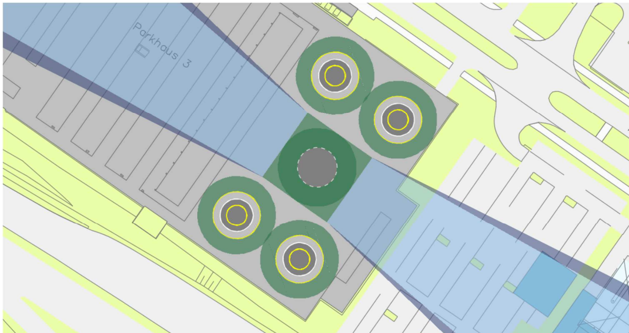
Abbildung 39: P3 Vertiport für 15 Meter größte Gesamtabmessung eVTOL, Konfiguration 2
