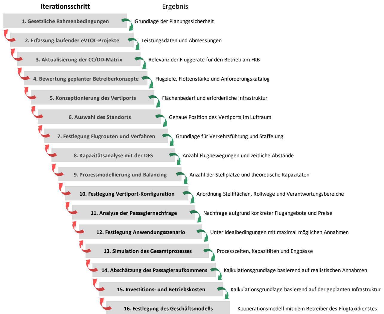
Abbildung 29: Iterationsmodell zur Gesamtkonzeption eines Vertiports am FKB
