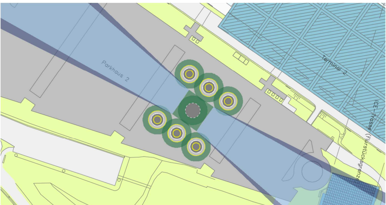
Abbildung 33: P2 Vertiport für 12 Meter größte Gesamtabmessung eVTOL, Konfiguration 2
