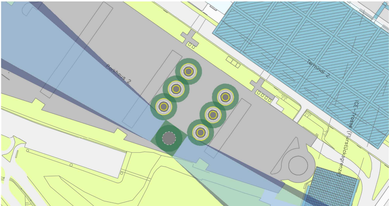
Abbildung 32: P2 Vertiport für 12 Meter größte Gesamtabmessung eVTOL, Konfiguration 1
