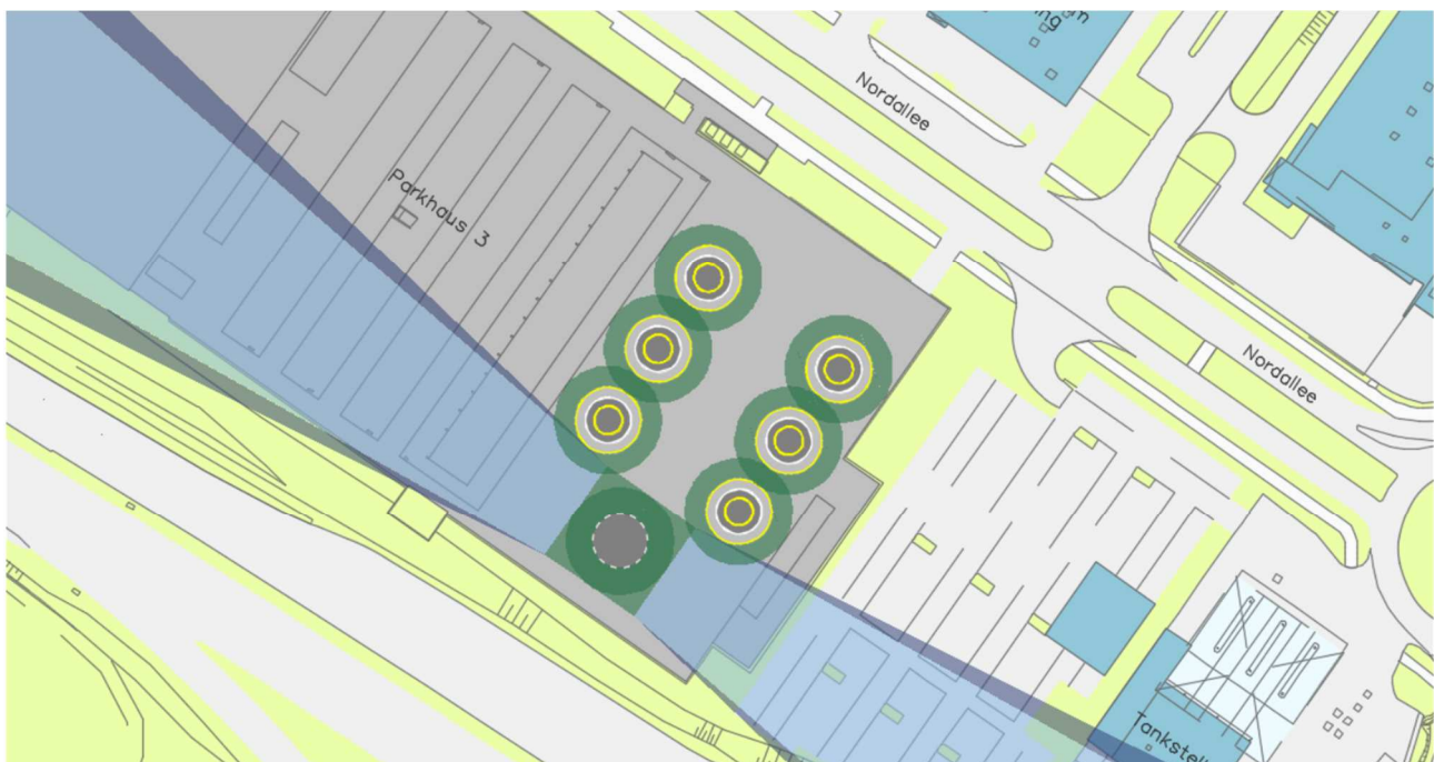
Abbildung 36: P3 Vertiport für 12 Meter größte Gesamtabmessung eVTOL, Konfiguration 1
