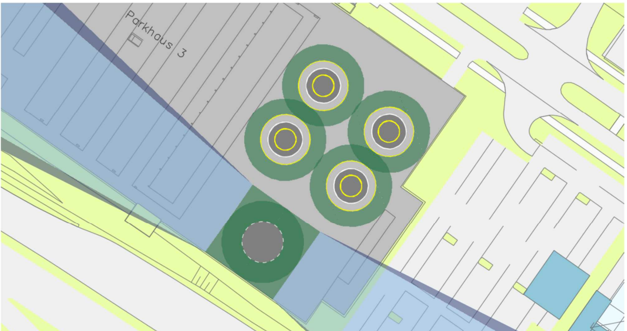
Abbildung 38: P2 Vertiport für 15 Meter größte Gesamtabmessung eVTOL, Konfiguration 1
