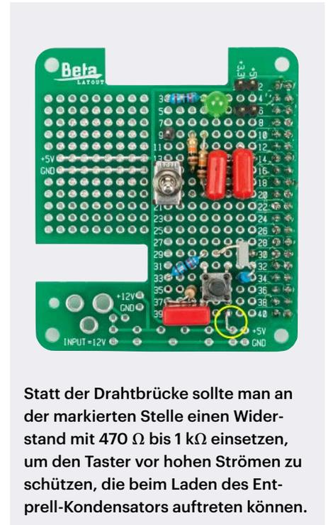
Statt der Drahtbrücke sollte man an der markierten Stelle einen Widerstand mit 470Ω bis 1kΩ einsetzen, um den Taster vor hohen Strömen zu schützen, die beim Laden des Entprell-Kondensators auftreten können.
