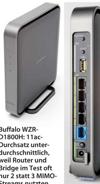
**Buffalo WZR-D1800H: 11ac-Durchsatz unterdurchschnittlich, weil Router und Bridge im Test oft nur 2 statt 3 MIMO-Streams nutzen**
