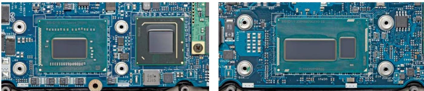
Bislang gehörte zum Ultrabook-Prozessor noch ein separater Chipsatz (links), bei der SOC-Variante von Haswell sitzen beide Dice auf einem Träger (rechts).
