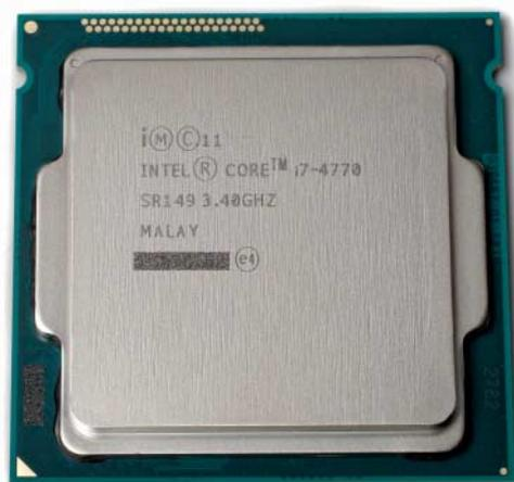
Während Intels Mobilprozessoren das nackte Silizium-Die zeigen, verbergen es die Chips für Desktop-PCs unter einem Heatspreader. Dieser verteilt nicht nur die Wärme, sondern schützt auch den empfindlichen Chip. Das vereinfacht die Montage des Kühlkörpers.
