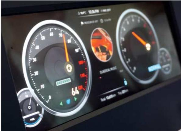
LG legt die Zeiger mit einem transparenten OLED über die LCD-Anzeige und erzeugt so einen 3D-Eindruck.
