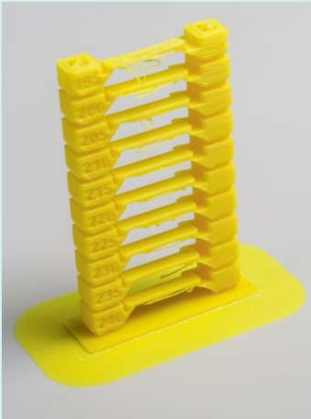
An Temperaturtürmen sieht man, bei welcher Düsentemperatur ein 3D-Drucker einen Kunststoff am saubersten verarbeitet. Um einen solchen zu drucken, müssen Sie aber G-Code von Hand modifizieren.
