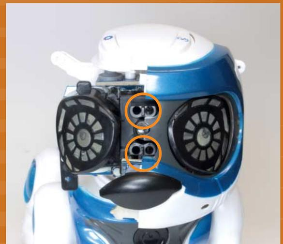
Die Photodiode in der Mitte erkennt, wenn man ihm das Gesicht zuhält, um in den Befehlsmodus zu wechseln. Danach erkennt das Hundehirn mit Hilfe der beiden Reflexlichtschranken über seiner Nase, ob vor ihm eine Hand abwärts (Befehl „Platz“) oder aufwärts („Spring“) bewegt wird. Dort sitzt auch ein Mikrofon für die Fernsteuerung per Tablet.
