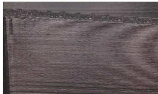
4 Treppenstufen auf einem Modell mit horizontal gedruckter Oberfläche
