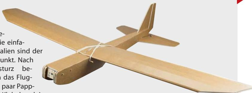
Deutschland ist nur das Speed Build Kit erhältlich, die Elektronik bekommt man aber in jedem Modellbauladen. Zusätzlich gibt es die Laservorlagen für die Bauteile kostenlos auf der Webseite von Flite Test. Wer möchte, kann die Leichtschaumplatte selbst mit Laser oder Cutter zuschneiden. —rehu
