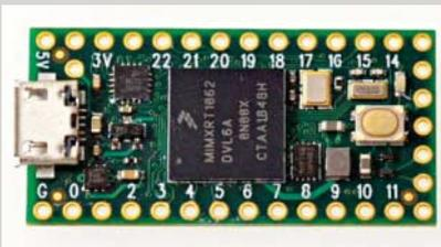
Gestenerkennung, Sprachausgaben und Echtzeitaudioanalysen – mit dem neuen Teensy 4.0 soll das auf Mikrocontrollern einfach umzusetzen sein. Das kleine Board bringt dafür den ARM Cortex-M7 mit 600MHz und ist laut Hersteller PJRC mehr als fünf Mal schneller als sein Vorgänger Teensy 3.6. Dazu kommen 1024K RAM und 2048K Flashspeicher. Prinzipiell sei sogar noch mehr Geschwindigkeit möglich, denn der Chip lasse sich übertakten.
