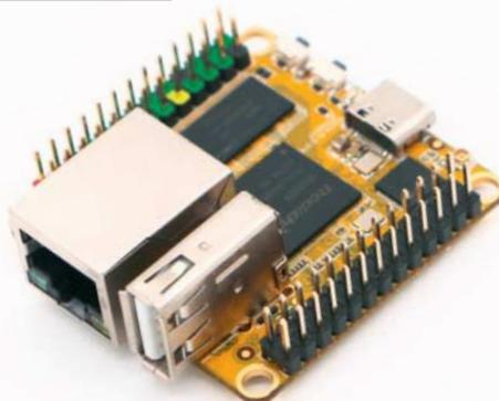
se, die zugleich für die Stromversorgung zuständig ist (5V). An den Rändern der Platine finden zwei Pinleisten Platz, die neben den zahlreichen Mikrofonports auch serielle Schnittstellen, SPI oder I2C bereitstellen.
