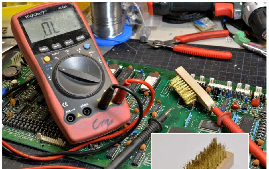
Mit der Fehlersuchbürste lassen sich Verbindungen und Unterbrechungen schneller auffinden, weil sie viele Pins gleichzeitig berührt.
