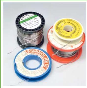
Lötzinn wird schon bei rund 190 °C flüssig. Außerdem enthält Lötzinn, egal ob bleihaltig oder bleifrei, sogenannte Flussmittel. Diese Substanzen sorgen dafür, dass das Lötzinn besser fließt und reinigen die Lötstelle von Oxidationen. Das soll sicherstellen, dass eine stabile und elektrisch leitfähige Verbindung zustande kommt.
