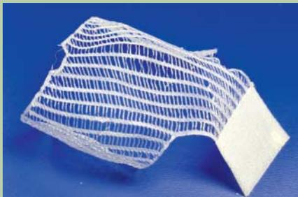
die abgebildete Klickschnalle bleiben beim Druck formstabil. Über die Fülldichte kann man relativ gut einstellen, wie steif das spätere Teil werden soll. Dank der Bruchfestigkeit ist Nylon sicher auch die richtige Wahl bei Objekten mit Filmscharnieren. Das „Raft“ eines fehlgeschlagenen Drucks stellte sich außerdem als sehr reißfestes, grobmaschiges Gewebe heraus.
