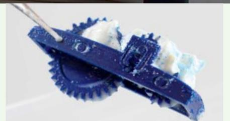
den beiden Düsen mit entsprechendem Materialvor- und -nachlauf führt aber insgesamt zu etwas unsaubereren Ergebnissen. —pek
