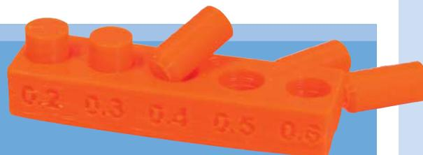
in Richtung der drei Raumachsen war beeindruckend, Spalten müssen allerdings mindestens 0,4 Millimeter breit sein, damit Teile getrennt gedruckt werden.
